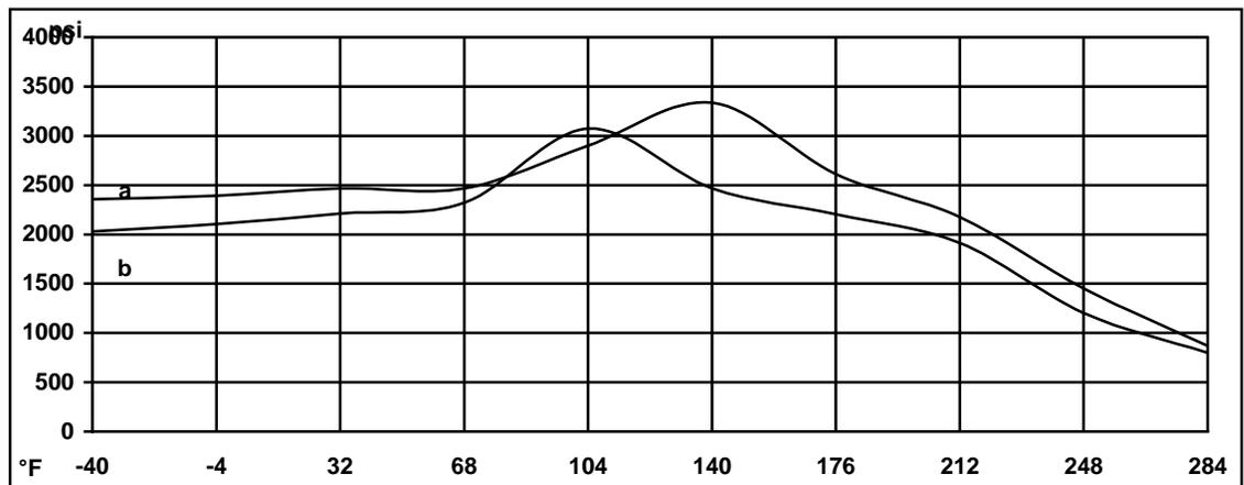
**Roller peel test (ISO 4578)**
